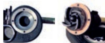
Turbine en acier moulé (sur pompe 7 m)
