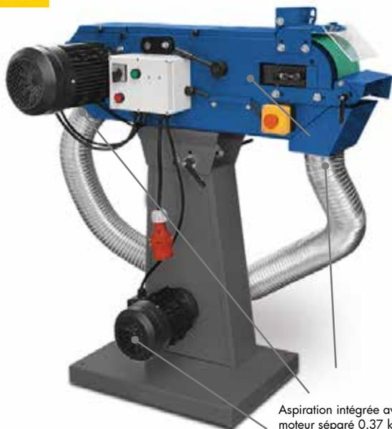
Aspiration intégrée avec moteur séparé 0,37 kW dans le pied avec sac filtrant en polyester
