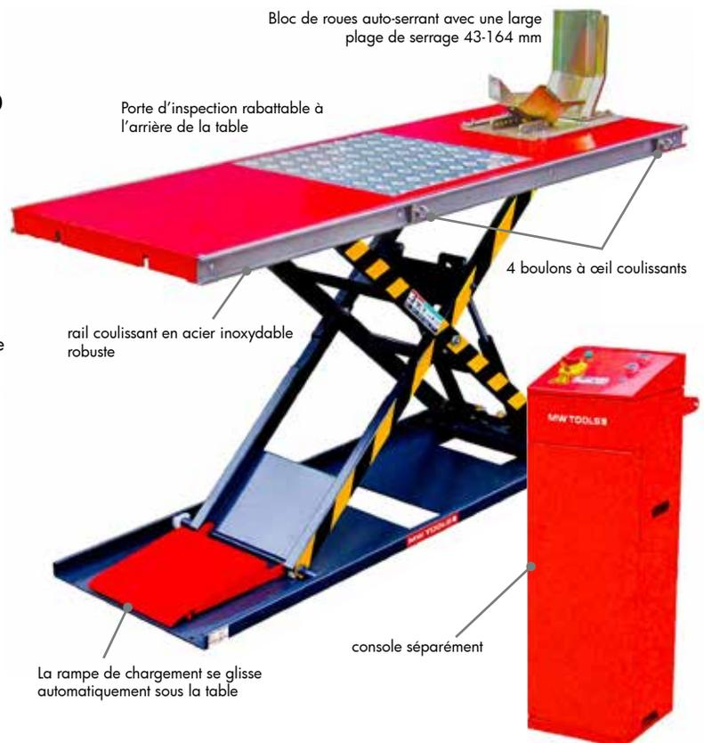
Bloc de roues auto-serrant avec une large plage de serrage 43-164 mm
