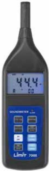
**Sonomètre numérique 2 courbes de filtre A et C, mesure rapide et lente**
