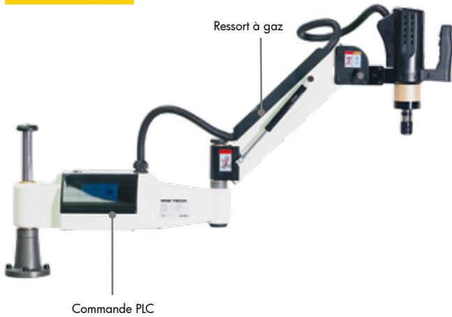
Bras de taraudage électrique avec écran tactile, commande PLC et Réglage de la vitesse variable
