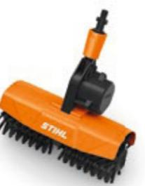
Pour nettoyer en douceur des surfaces étendues et délicates (par ex. terrasses avec revêtement en bois ou en pierre, façades ou portes de garage). Selon les besoins, elle peut être montée directement sur le pistolet, sur la lance ou également sur la lance télescopique STIHL. Remplacement facile de la brosse grâce au système de fermeture rapide. Largeur de travail d'environ 30 cm.
