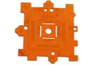
Pour mesurer le pas de la chaîne et du pignon de chaîne, l'épaisseur des maillons d'entraînement et la largeur de rainure du guide.
