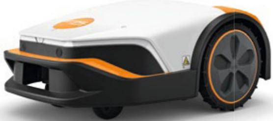
Tondeuse robot compacte et maniable pour une tonte entièrement automatique. Système de tonte doté de trois lames mobiles, coupe impeccable. Coupe, hache et fertilise l'herbe d'une seule traite. Réglage mécanique de la hauteur de coupe. Peut gravir des pentes jusqu'à 40 %. Largeur de coupe : 20 cm. Utilisation intuitive. Accès par l'application MY iMOW® avec Bluetooth® et WLAN.
