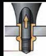
2. Prenez les pinces et mettez l'écrou du rivet aveugle par-dessus et tapez l'arrière de l'écrou dans le trou. La pince tire alors l'arrière de l'écrou du rivet vers l'arrière, ce qui le déforme à l'extérieur et le verrouille en place.
