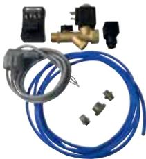
L'électrovanne est fabriquée en acier inoxydable et bénéficie d'une protection IP65. Cette électrovanne fonctionne de 0 à 16 bars. Le raccord est un filetage femelle de ½".
