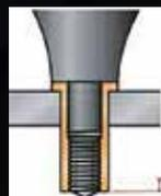
1. Percez un trou dans la construction de la taille de l'écrou de rivet que vous choisissez.
