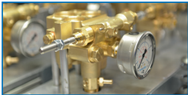
Tête de pompe en laiton spécial avec manomètre en inox
