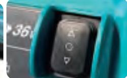
Inclinaison électrique de la cuve (DCU602) ou levage du plateau (DCU601)
