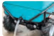
La cuve plate est équipée d'un dispositif d'évacuation de l'eau.
