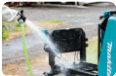
Compatible WetGuard/ IPX4 : la machine résiste aux éclaboussures d'eau et peut également être rincée.
