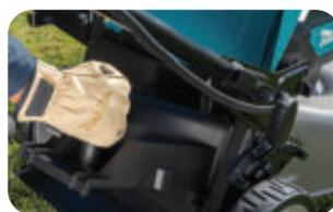
Basculement facile vers le mulching à l'aide d'un bouchon
