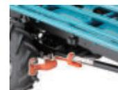
L'arbre de transmission peut être déconnecté pour fonctionner à faible résistance lorsque le moteur ne tourne pas.
