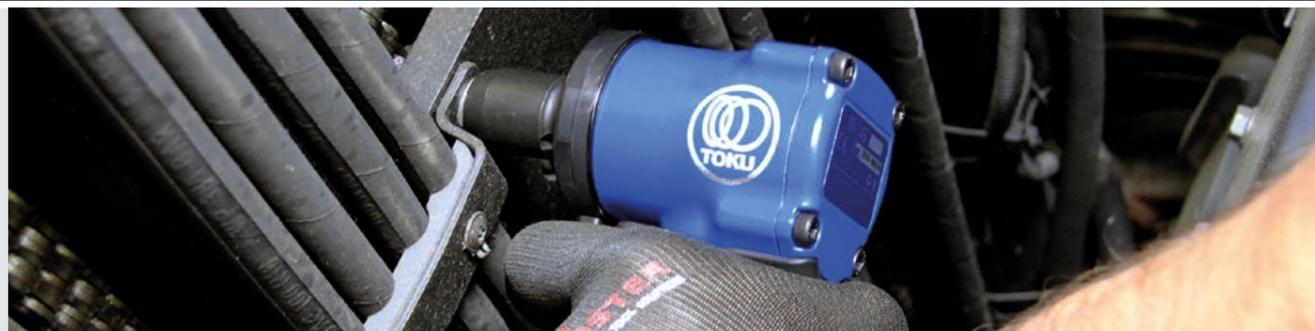
La clé à chocs est l'outil à air comprimé le plus connu. Elle est utilisée quasiment partout (ateliers, garages, construction navale, pétrochimie et industrie) où de nombreux boulons et écrous doivent être vissés ou dévissés. Les clés à chocs existent en plusieurs versions, en forme de pistolet, droit et à angle droit, et en différentes tailles, avec un carré d'entraînement à partir de 3/8" jusqu'à 2 1/2".
