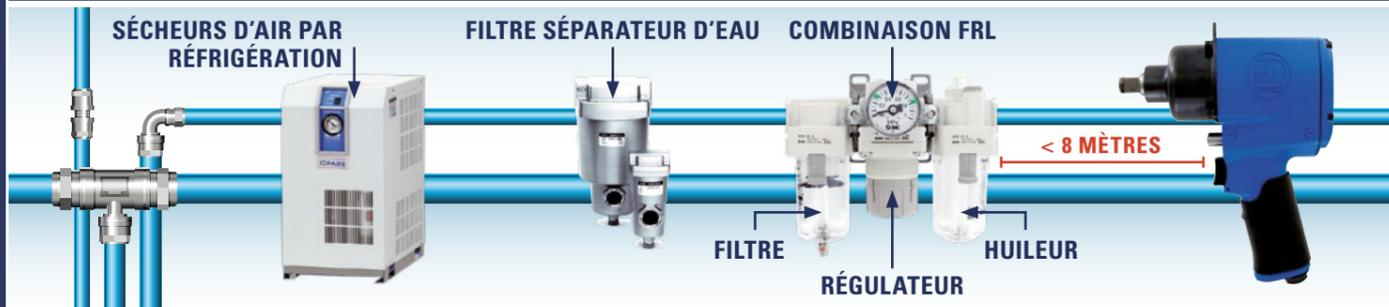
**80-90 % DES RÉPARATIONS D'OUTILS PNEUMATIQUES SONT CAUSÉS PAR LA MAUVAISE QUALITÉ DE L'AIR COMPRIMÉ**
