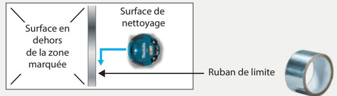
Au moyen d'un ruban de limite, l'utilisateur peut délimiter la zone à l'intérieur de laquelle le robot peut nettoyer.
