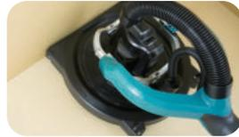
Le côté droit du capot de protection du DSL800 permet de le déplacer le long d'un mur ou d'un plafond.
